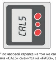
Поверните прибор на 90° по часовой стрелке на том же самом месте и нажмите кнопку НОЛЬ. Пиктограмма «CAL5» сменится на «PASS», затем на «0.00».
