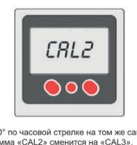
Поверните прибор на 90° по часовой стрелке на том же самом месте и нажмите кнопку НОЛЬ. Пиктограмма «CAL2» сменится на «CAL3».
