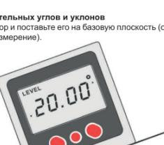
Обнулите показания прибора, нажав кнопку НОЛЬ. Показания прибора на дисплее изменятся на «0», погаснет надпись LEVEL на дисплее, что показывает активацию режима относительных значений.
