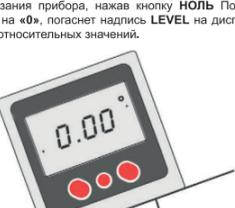
Перенесите прибор на вторую плоскость, уровень (уклон) которой необходимо измерить. На дисплее будет выведено значение угла наклона (уклона) относительно первой (базовой) поверхности.
