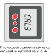
Поверните прибор на 90° по часовой стрелке на том же самом месте и нажмите кнопку НОЛЬ. Пиктограмма «CAL3» сменится на «CAL4».
