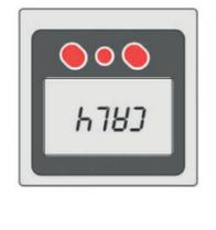
Поверните прибор на 90° по часовой стрелке на том же самом месте и нажмите кнопку НОЛЬ. Пиктограмма «CAL4» сменится на «CAL5».
