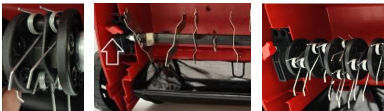
спереди) необходимо открутить гайку-барашек, снять пластину, вынуть один аксессуар, вставить другой и зафиксировать его в обратном порядке. Замена производится за пару минут.
