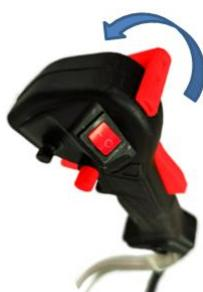
Чтобы снизить нагрузку на руку пользователя в случаях, если работать предстоит многие часы, на моделях установлена правая рукоятка с функцией активного «круиз контроля», где плавным перемещением специального рычага можно выбрать оптимальный баланс между развивающимися оборотами и плотностью травы на участке. При этом добиться не только качественно сделанной работы, но и экономии топливной смеси, что означает большее время работы оборудования на одной заправке.
