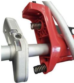
На моделях установлена коммерческого класса антивибрационная система с металлическими пружинами, которая способствует снижению нагрузки на тело оператора при длительной эксплуатации инструмента. Учитывая особенности дизайна и исключительно для удобства пользователей, поставки моделей осуществляются в единой упаковке, что минимизирует трудозатраты на сборку и подготовку инструмента к работе.
