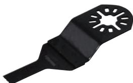
Насадка по металлу BIM M42 (за исключением закалённых саморезов и твердосплавных металлов); ширина 10 мм; глубина пропила 40 мм; толщина 0,8 мм; 18 TPI
