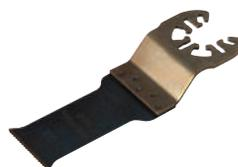
Насадка по металлу ВМ М42 (за исключением закалённых саморезов и твердосплавных металлов); ширина 28 мм; глубина пропила 50 мм; толщина 0,8 мм; 18 TPI
