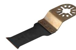
Насадка по металлу BIM M42 (за исключением закалённых саморезов и твердосплавных металлов); ширина 28 мм; глубина пропила 50 мм; толщина 0,8 мм; 18 TPI
