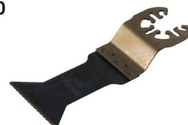
Насадка по металлу ВМ М42 (за исключением закалённых саморезов и твердосплавных металлов); ширина 44 мм; глубина пропила 50 мм; толщина 0,8 мм; 18 TPI
