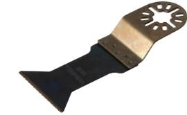
Насадка по металлу BIM M42 (за исключением закалённых саморезов и твердосплавных металлов); ширина 44 мм; глубина пропила 50 мм; толщина 0,8 мм; 18 TPI
