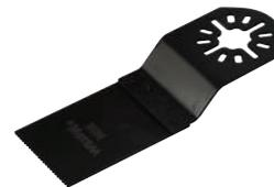
Насадка по металлу BIM M42 (за исключением закалённых саморезов и твердосплавных металлов); ширина 32,5 мм; глубина пропила 40 мм; толщина 0,8 мм; 18 TPI
