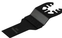
Насадка по металлу ВМ М42 (за исключением закалённых саморезов и твердосплавных металлов); ширина 20 мм; глубина пропила 40 мм; толщина 0,8 мм; 18TPI
