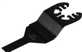
Насадка по металлу ВМ М42 (за исключением закалённых саморезов и твердосплавных металлов); ширина 10 мм; глубина пропила 40 мм; толщина 0,8 мм; 18 TPI
