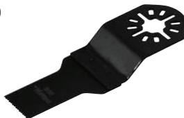
Насадка по металлу BIM M42 (за исключением закалённых саморезов и твердосплавных металлов); ширина 20 мм; глубина пропила 40 мм; толщина 0,8 мм; 18 TPI
