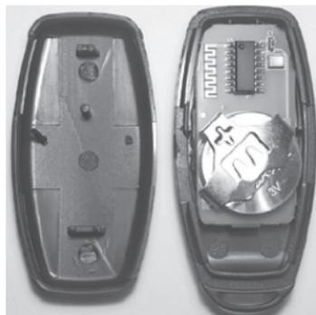
Для замены элемента сілкавання акуратна адкрыйце корпус пульта дыстанцыйнага кіравання. Корпус пульта фіксуецца на зашчэпках. Выміце з трымальніка элемент сілкавання. Усталюйце ў трымальнік новы элемент сілкавання. Тып выкарыстоўванага элемента сілкавання CR 2032.
