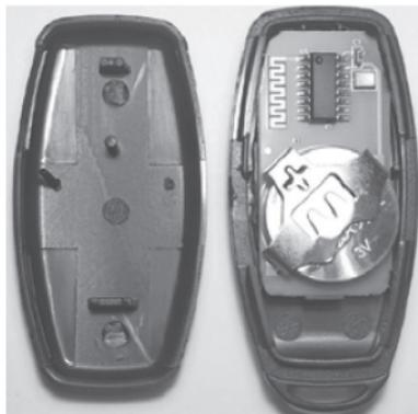
Батареяны ауыстыру үшін қашықтан басқару құралының корпусын абайлап ашыңыз. Қашықтан басқару құралының корпусы ысырмалармен бекітілген. Қуат элементін ұстағыштан шығарыңыз. Ұстағышқа жаңа қуат элементін орнатыңыз. Қолданылатын қуат элемент түрі - CR 2032.
