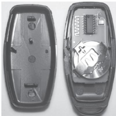
Для замены элемента питания аккуратно откройте корпус пульта дистанционного управления. Корпус пульта фиксируется на защелках. Извлеките из держателя элемент питания. Установите в держатель новый элемент питания. Тип используемого элемента питания CR 2032.
